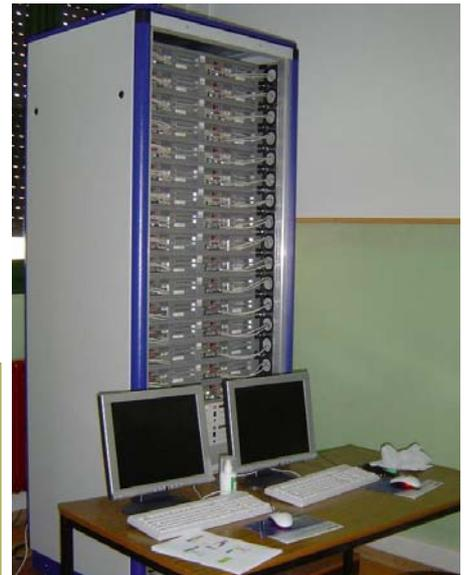
Armario con 32 procesadores Pentium IV a 3,20GHz ensamblado por la empresa Megware en 16 cajas de forma RU. El peso total del sistema es de unos 800Kg. El sistema de ventilación incluido permite a los nodos permanecer por debajo de los 40 grados en condiciones de carga máxima.
