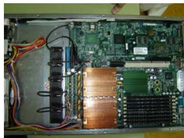
Placa base en la que se observa el sistema de ventilación peculiar de este tipo de nodos de computación. En la fotografía se observan dos Xeon EMT64, 4GB de RAM y la placa base de Supermicro. Una línea de 5 mini-ventiladores mantiene las CPUs a temperatura aceptable de trabajo
