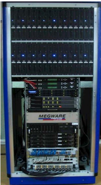
Armario diseñado por la empresa Megware con 36 cajas duales. Cada caja tiene 2 xeon emt64 en configuración dual a 3,40GHz, una memoria de 4GB y disco duro de 80GB.
